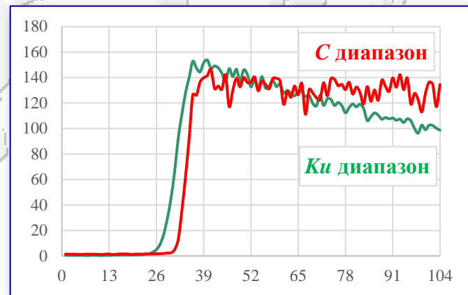
Мощность отражённого импульса после фурье-преобразования — «форма» отражённого импульса
