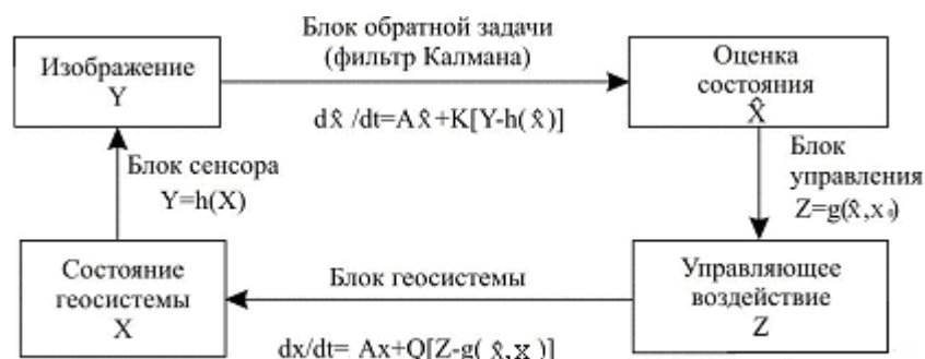
Рис. 1. Структурная схема замкнутого цикла мониторинга и управления состоянием природных и антропогенных объектов
