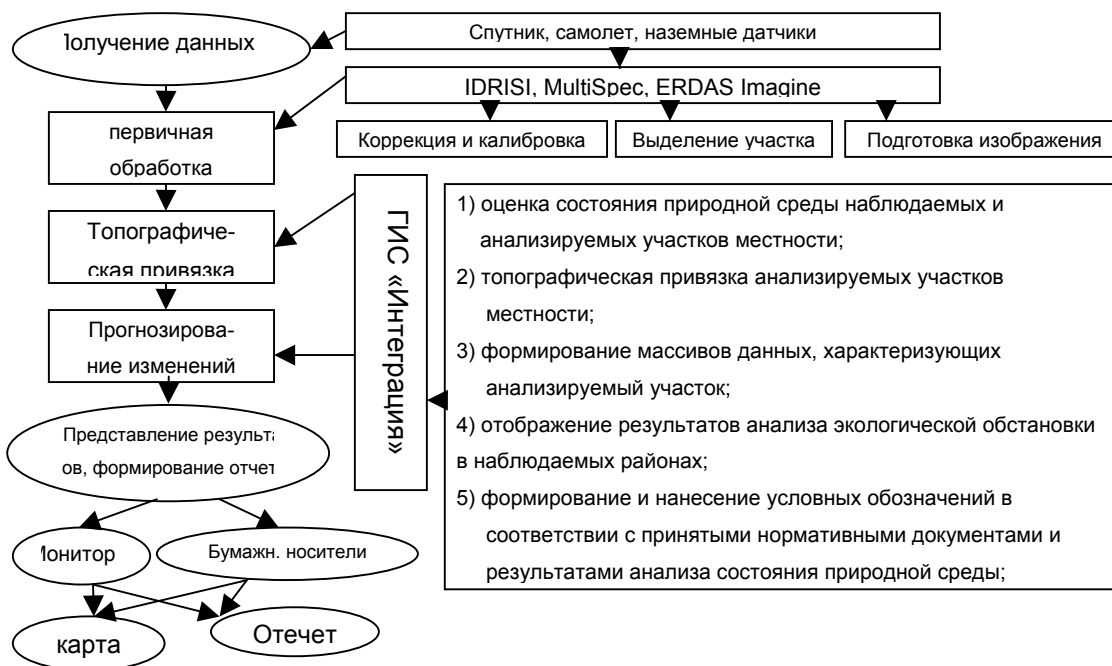
Рис. 3. Общая структурная схема средств сбора, обработки и представления информации, обеспечивающих представление исходных данных для моделирования экологических событий
