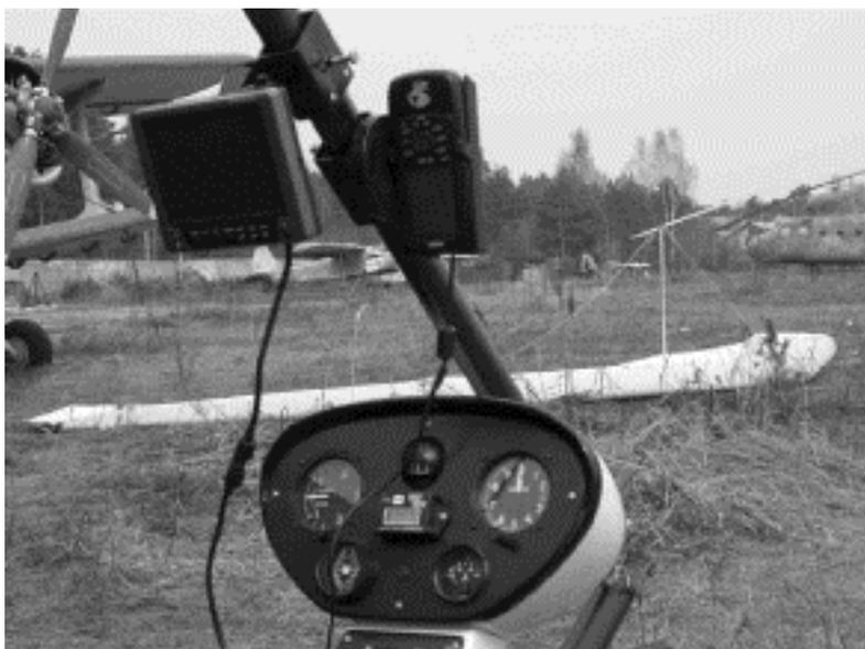
Рис. 7. Приборная доска и GPS приемник с жидкокристаллическим видеомонитором на борту МДП
