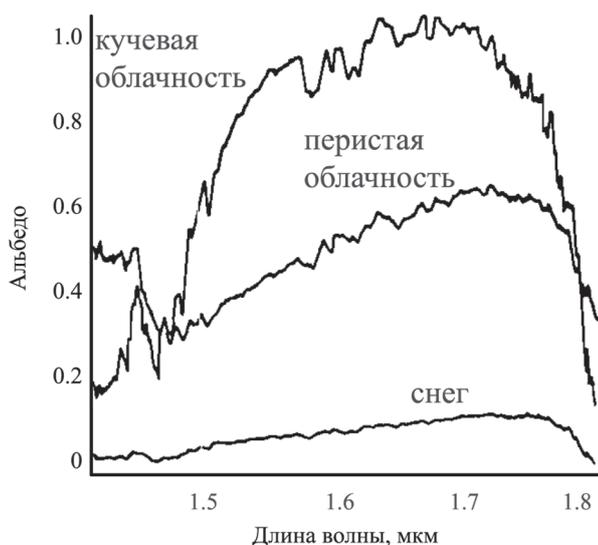
Рис. 2. Альбедо снежного покрова в спектральном диапазоне от 1,4 до 1,8 мкм
