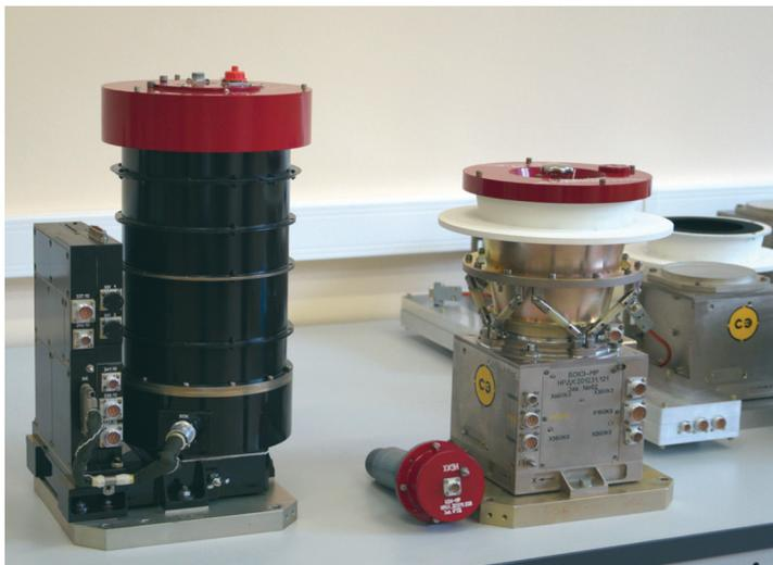
Рис. 1. Прибор звёздной ориентации предыдущего поколения (слева), прибор звёздной ориентации нового поколения (справа)
