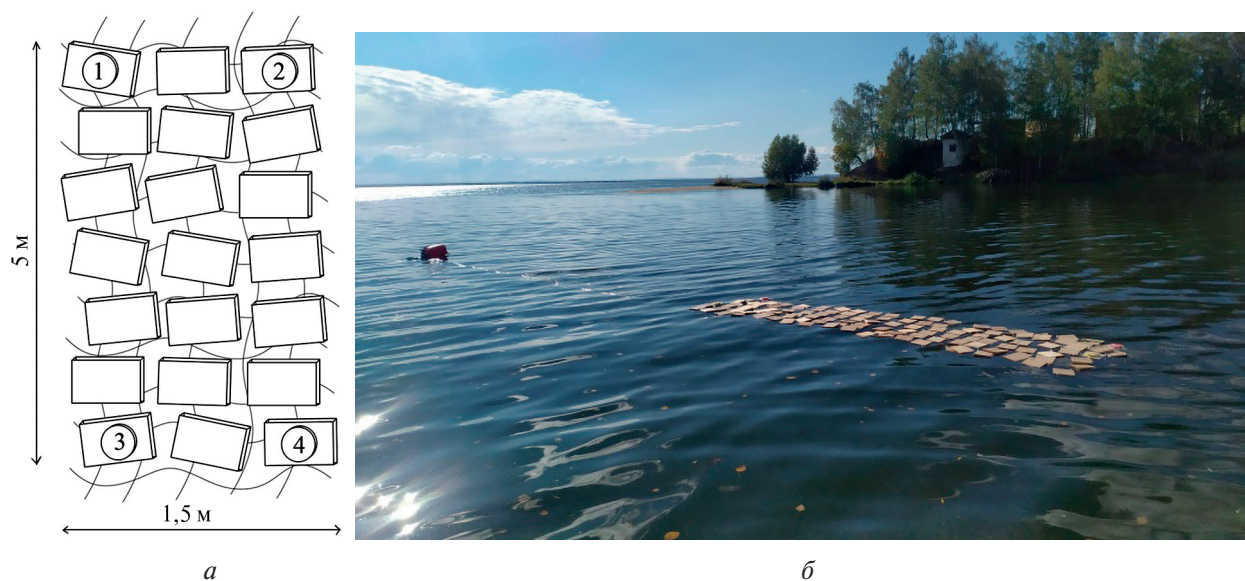
Рис. 5. Схематичное изображение имитаторов льда, закреплённых на капроновой сетке ( а ); номерами обозначены положения закреплённых акселерометров. Фотография имитаторов льда, привязанных к заякоренному буйку ( б )
