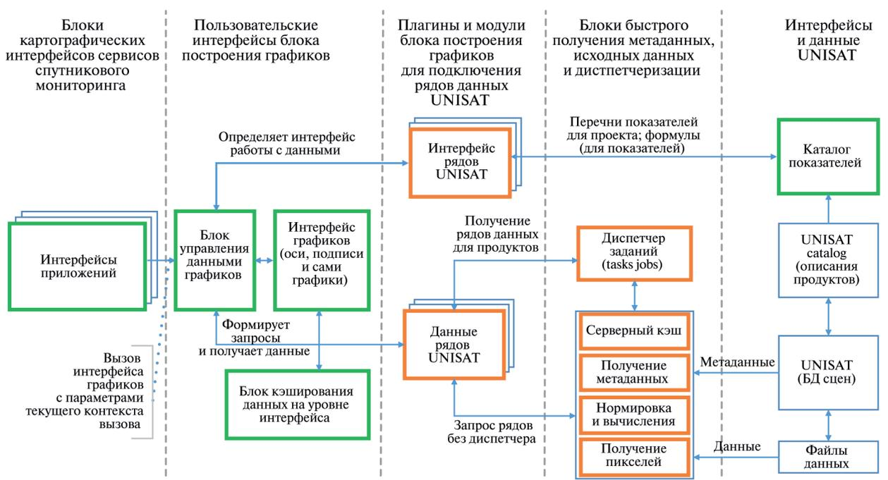
Рис. 1. Общая схема структуры и блоков сервисов доступа к временным сериям в инфраструктуре ЦКП «ИКИ-Мониторинг»
