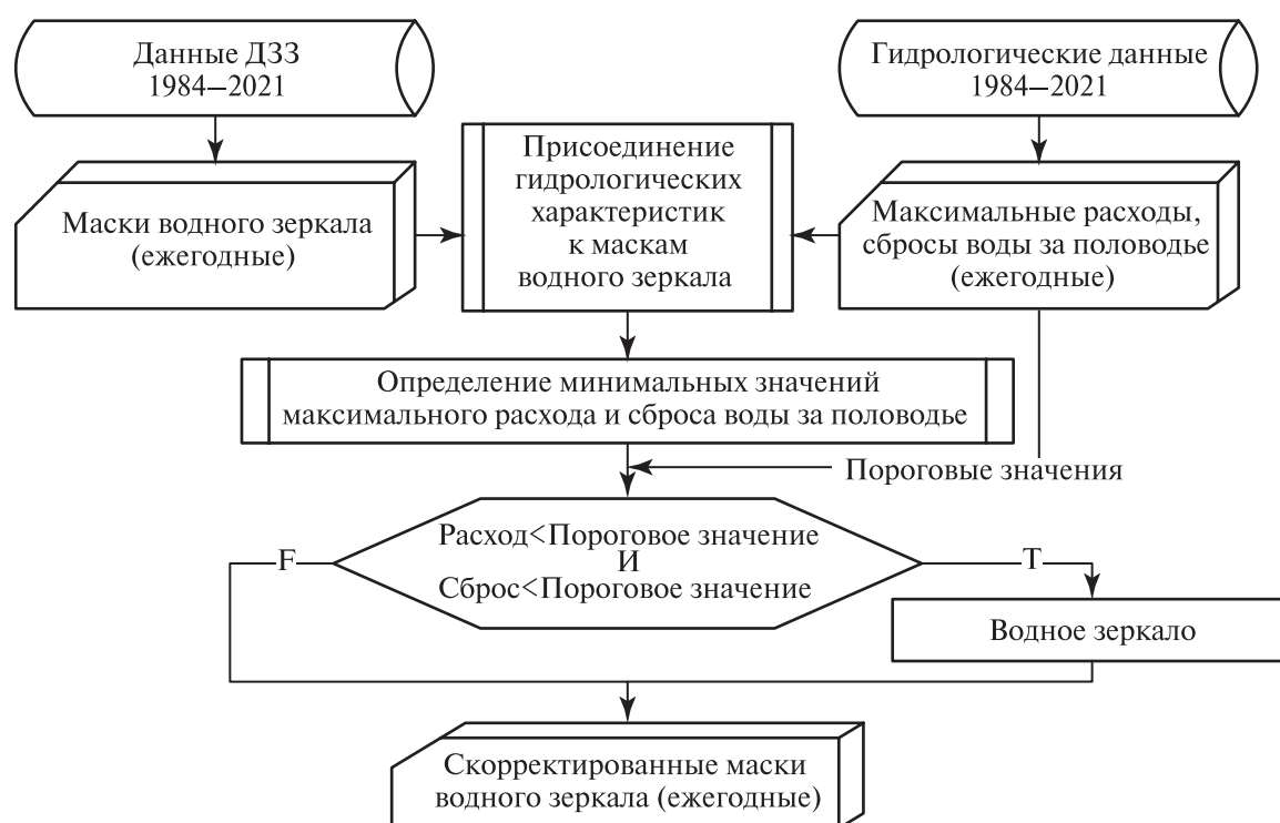
Рис. 4. Схема картографирования водного зеркала по данным ДЗЗ с корректировкой по гидрологическим данным максимального расхода и сброса воды на пике половодья
