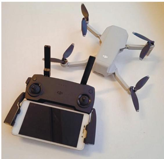
Рис. 1. Беспилотный аппарат DJI Mavic Mini
