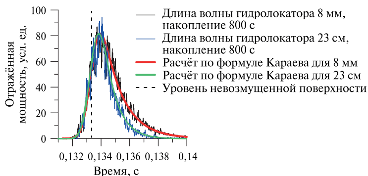
Рис. 4. Сравнение отражённых импульсов, полученных в результате численного моделирования и по формуле Караева, для длин волн гидролокаторов 8 мм и 23 см
