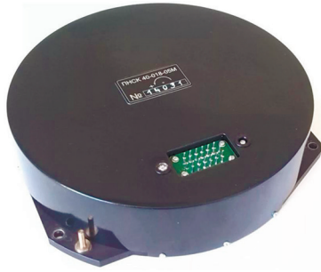
Рис. 3. Одноосный измеритель угловой скорости, установленный на малом космическом аппарате дистанционного зондирования Земли «Аист-2Д»
