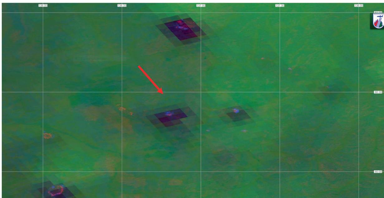
*Рис. 4.* Цветосинтезированное изображение по данным наблюдений в спектральных каналах в районе 3,7 мкм за 30.06.2023: канал Red (R, красный) — VIIRS 02:21 GMT; канал Green (G, зелёный) — МСУ-ГС/ВЭ 10:30 GMT; канал Blue (B, синий) — VIIRS. Красные и синие участки — тепловые аномалии на данных VIIRS, тёмные участки — тепловые аномалии на данных МСУ-ГС/ВЭ. Стрелка указывает на пожар к-457 (Республика Саха (Якутия))
