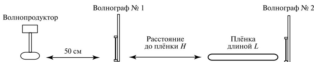
Рис. 1. Схема эксперимента по измерению затухания ГКВ на плёнках
