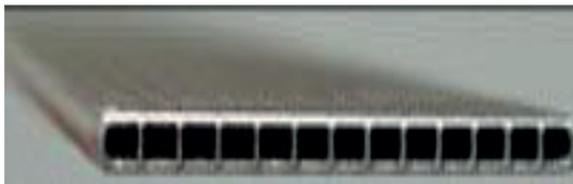
Рис. 3. Микроканалы внутри пластины (Refrion)
