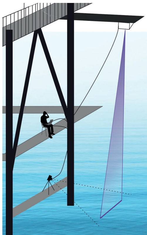
Рис. 1. Схема измерений формы морской поверхности сканирующим лазерным волнографом
