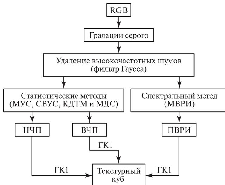
Рис. 2. Схема текстурной обработки. НЧП — низкочастотные признаки; ВЧП — высокочастотные признаки; ПВРИ — признаки вейвлет-рассеяния изображений; ГК1 — первая главная компонента
