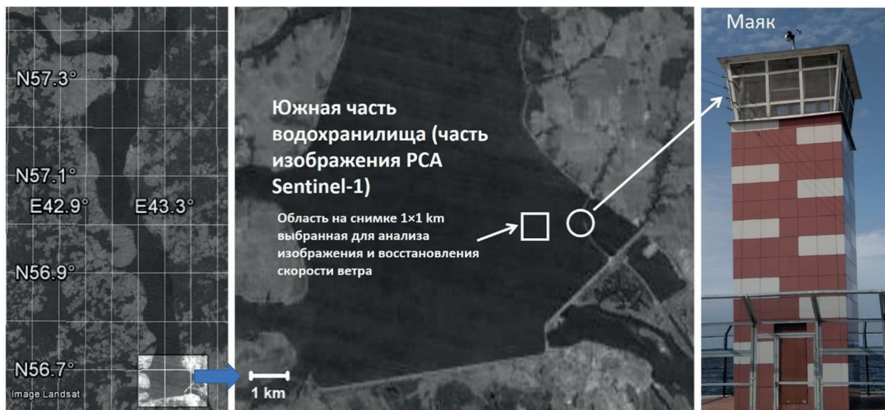
Рис. 1. Карта Горьковского вдхр. (слева); южная часть водохранилища с указанием расположения маяка, где установлена станция, и области, где вычисляется УЭПР (в центре); маяк с установленной на крыше станцией (справа)
