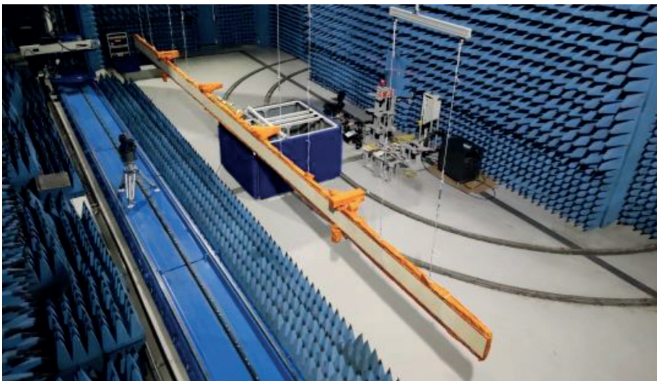
Рис. 6. Установка АФАР с образованием единой плоскости раскрыва
