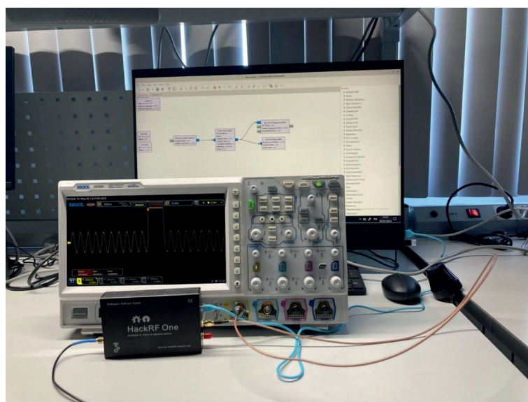
Рис. 2. Внешний вид стенда приёма и обработки ГНСС на HackRF One
