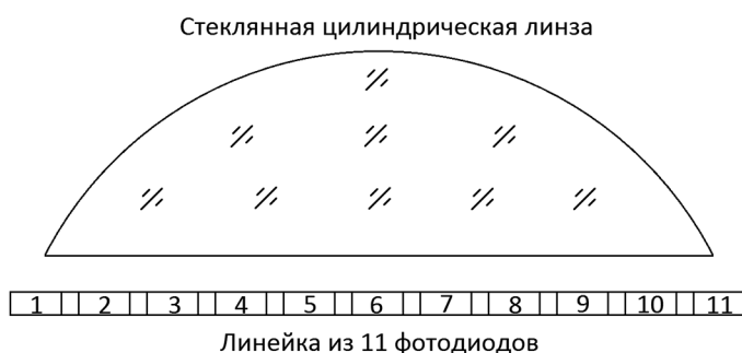
Рис. 5. Стеклоцилиндрическая линза и линейка фотодиодов в составе линейного фотодатчика; бленда не показана
