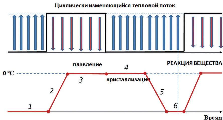
Рис. 6. Диаграмма работы идеального теплового аккумулятора
