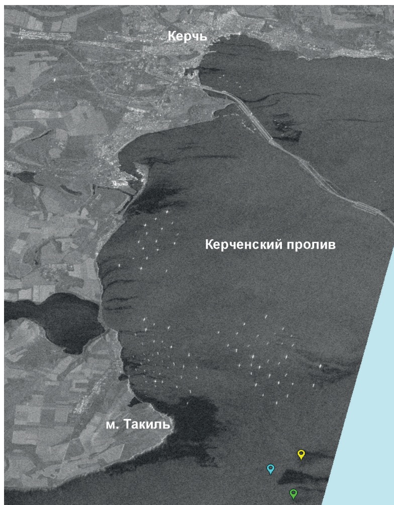
Рис. 3. Радиолокационное изображение SAR-C Sentinel-1A, полученное 23 декабря 2024 г. в 03:49:20 UTC к северо-западу от района аварии, которое включает береговую зону Крыма вплоть до Крымского моста и далее на север в Керченском проливе. Положение развалившихся частей танкеров отмечено цветными метками. Многочисленные белые точки — суда на данной акватории
