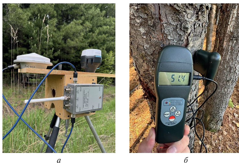
Рис. 2. Четырёхканальный приёмник-регистратор НСРП-04 (а) и портативный влагомер МС-7825PS (б)
