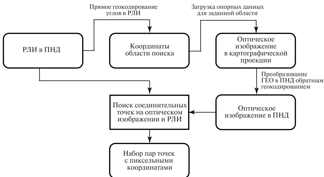
Рис. 1. Алгоритм автоматического поиска соединительных точек на РЛИ и оптическом опорном снимке
