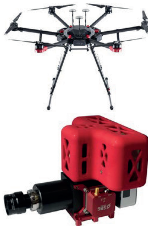
Рис. 2. Технические средства дистанционного гиперспектрального мониторинга засорённости делянок в опыте
