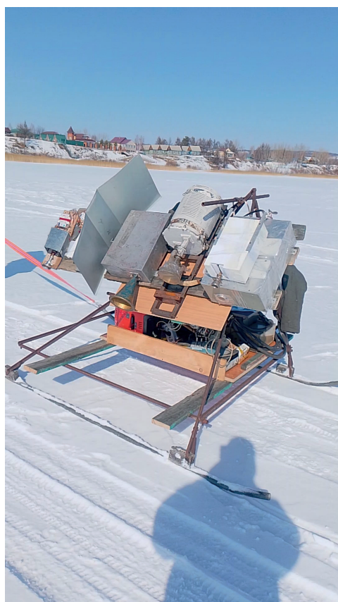
Рис. 4. Фотография приёмного комплекса с генераторами для измерения радиолокационных характеристик береговой зоны пресного водоёма
