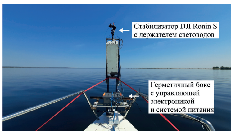
Рис. 2. Фотография размещения измерительного оборудования на борту судна
