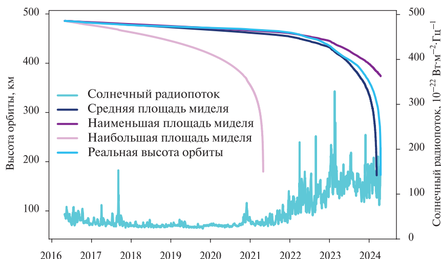
Рис. 10. Зависимость высоты орбиты МКА «Аист-2Д» при различных вариантах пространственной ориентации от времени
