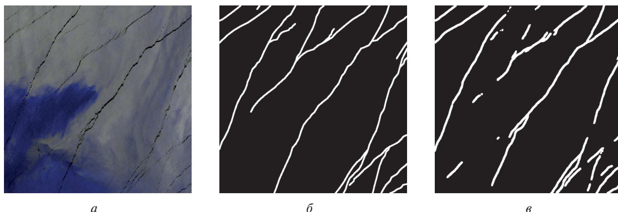
Рис. 1. Пример фрагмента исходного композитного изображения VIIRS размером 512×512 (а), соответствующая ему маска (б) и результаты, полученные моделью (в)
