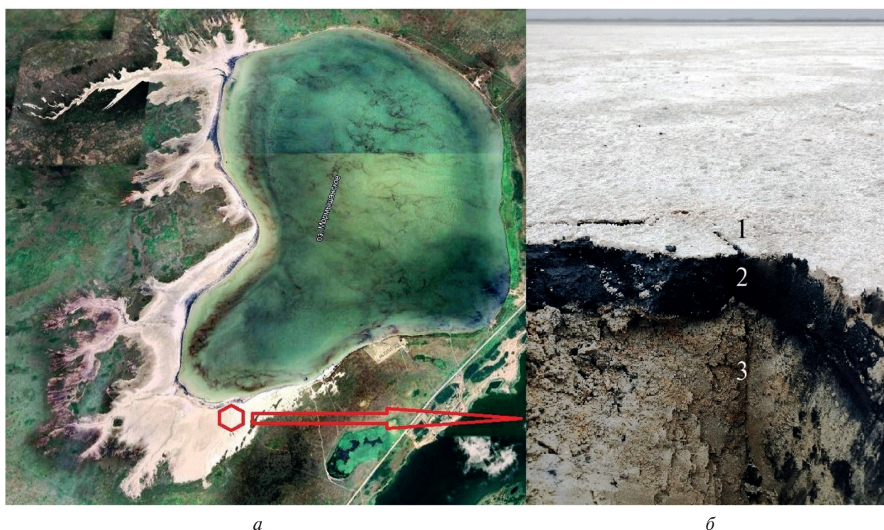
Рис. 1. Карта-схема солончака, расположенного в береговой зоне Мормышанского озера (а), и глубинное строение солончака (б). Шестиугольник красного цвета — участок исследований и место отбора проб солончакового грунта; 1, 2, 3 — номера слоёв
